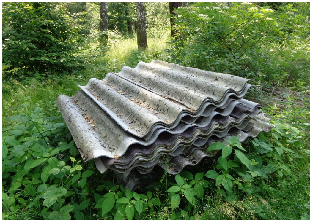
Rys 12. Azbest zmagazynowany w niewłaściwy sposób (Źródło: Fotografia własna)
