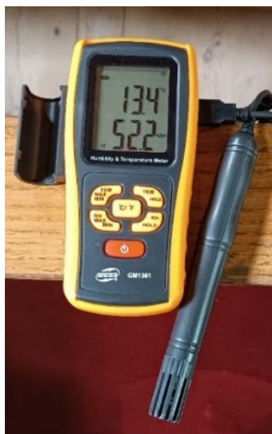
Rys 35. Pomiary temperatury, wilgotności względnej powietrza oraz wilgotności elementów drewnianych
