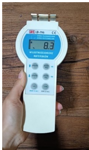
Rys 35. Pomiary temperatury, wilgotności względnej powietrza oraz wilgotności elementów drewnianych
