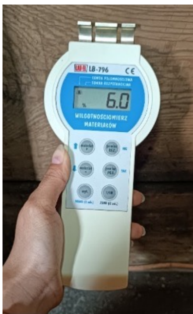
Rys 35. Pomiary temperatury, wilgotności względnej powietrza oraz wilgotności elementów drewnianych
